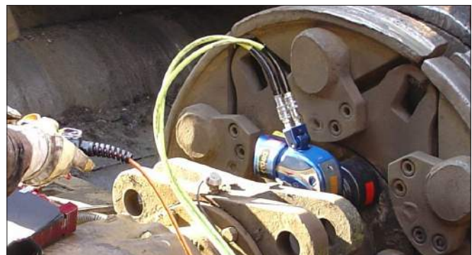
MXT-10 utilizada en una prensa de chatarra.
